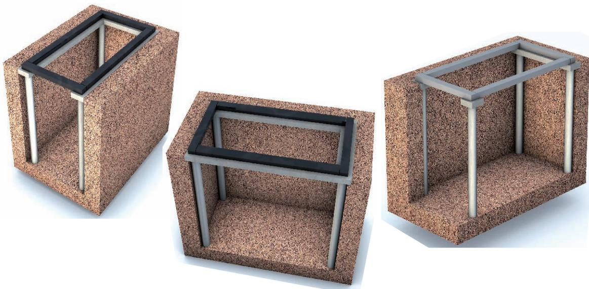
Figure 5. Fondation simple par longrines sur les 3 côtés reliés à des pilotis en béton armé
