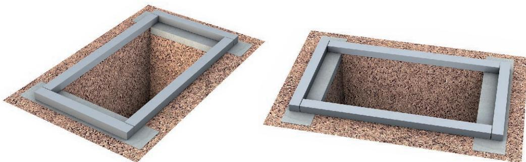
Figure 3. Fondation/assise simple par longrines à l'avant et à l'arrière
