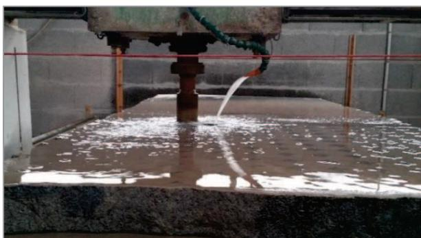
Machine à fabriquer des dalles podotactiles (Source : C. Corlay)
